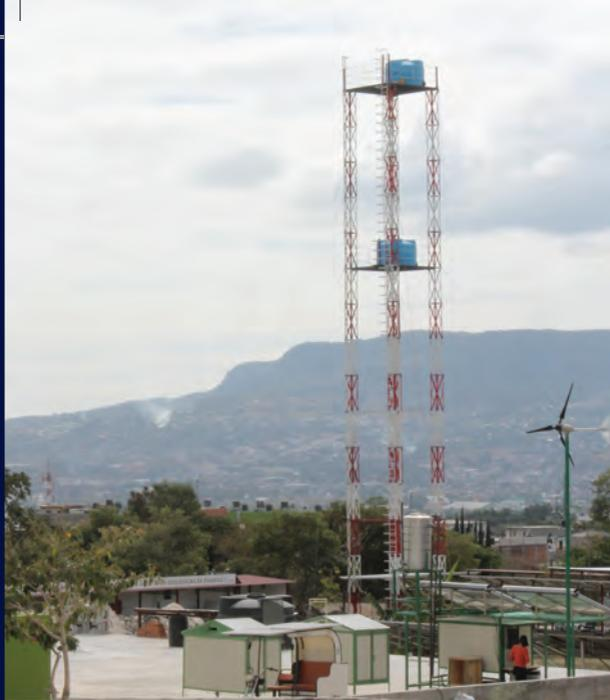
INSTALACIÓN DEL SISTEMA HIDRÁULICO PARA EVALUACIÓN DE BOMBAS SOLARES SUMERGIBLES.
